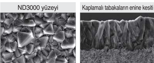
Yüksek sertlikte elmas kaplama (Hv 10,000) Mükemmel aşınma direnci sağlar Zirkonya için özelleştirilmiş kalite mükemmel yapışma sağlar
